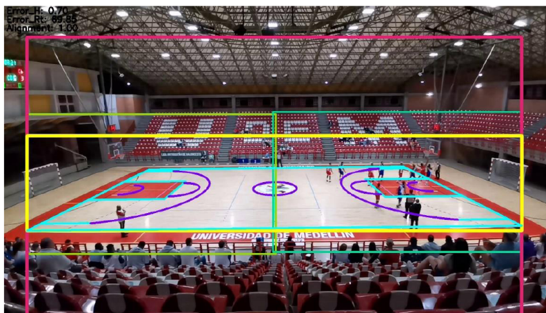
Figura 12. Calibración de la cancha de un partido de prueba de baloncesto. Fuente: Elaboración propia.
